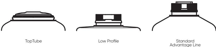
Beim Low Profile Verschluss muss aufgrund der kantigen Schulterform der Tubenschlauch entsprechend verlängert werden.
